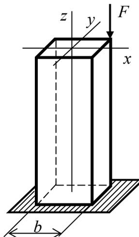
**Задача № 2.6.** Определить допускаемое значение силы  $F$ , внецентренно сжимающей стержень с двутавровым поперечным сечением № 36.
