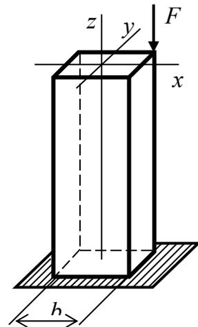
**Задача № 2.18.** Стержень сжимается внецентренно силой  $F = 180$  кН. Поперечное сечение стержня – двутавр № 40. Требуется:
