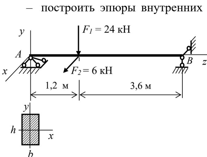
балки, определить положение опасного сечения;
