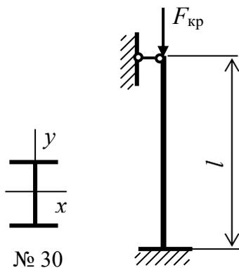
**Задача № 2.20.** Определить критическую силу для центрально сжатого стержня. Поперечное сечение стержня – двутавр № 30, материал – сталь Ст5;  $E = 2 \cdot 10^5$  МПа; длина стержня  $l = 4$  м; способ закрепления стержня показан на рисунке.
