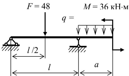
– определить поперечную силу и изгибающий момент на участках балки, построить эпюры  $Q_y$  и  $M_x$ ;
