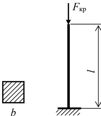
**Задача № 2.21.** Определить критическую силу для центрально сжатого стержня. Поперечное сечение стержня – квадрат со стороной  $b = 20$  см; длина стержня  $l = 3$  м; материал – дерево;  $E = 1 \cdot 10^4$ ; способ закрепления стержня показан на рисунке.
