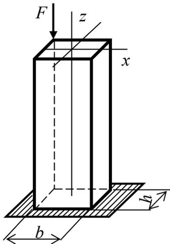
**Задача № 1.19.** Стержень сжимается внецентренно силой  $F$ . Поперечное сечение стержня – прямоугольник со сторонами  $b = 80$  см,  $h = 60$  см.
