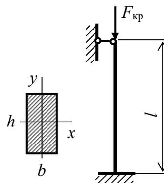
**Задача № 2.25.** Из условия устойчивости определить размер  $b$  квадратного поперечного сечения стержня, центрально сжатого силой  $F = 360$  кН.
