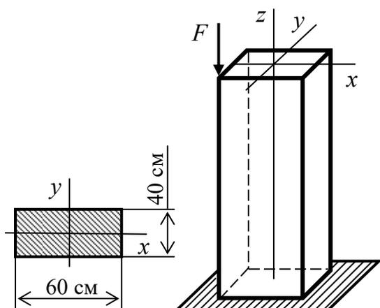
**Задача № 2.8.** Определить наибольшее напряжение в опасной точке прямоугольного поперечного сечения стержня, внецентренно сжатого стержня силой  $F = 400$  кН.
