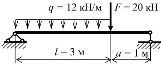
– определить внутренние усилия на участках балки и построить эпюры  $Q_y$ ,  $M_z$ ;
