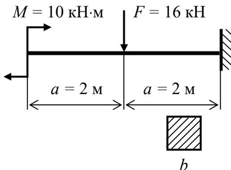
– определить внутренние усилия на участках балки и построить эпюры  $Q_y$  и  $M_x$ ;
