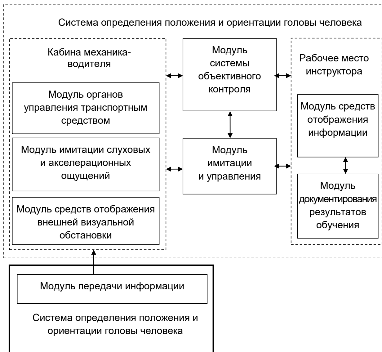
Рис. 4.13. Система определения положения и ориентации головы человека по стереоизображениям в структуре тренажера механика-водителя
