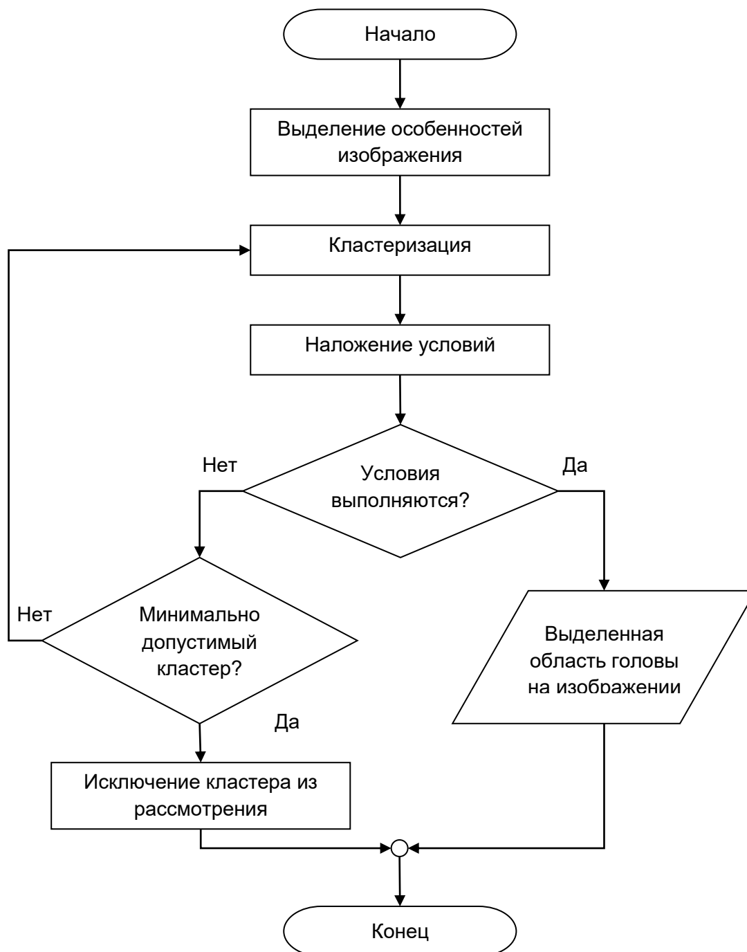
Рис. 2.14. Блок-схема алгоритма кластеризации особенностей на основе спектральной теории графов и ограничений для выделения лица человека на изображениях
