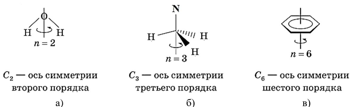
Рис. 5. Симметрия молекул воды (а), аммиака (б) и бензола (в)
