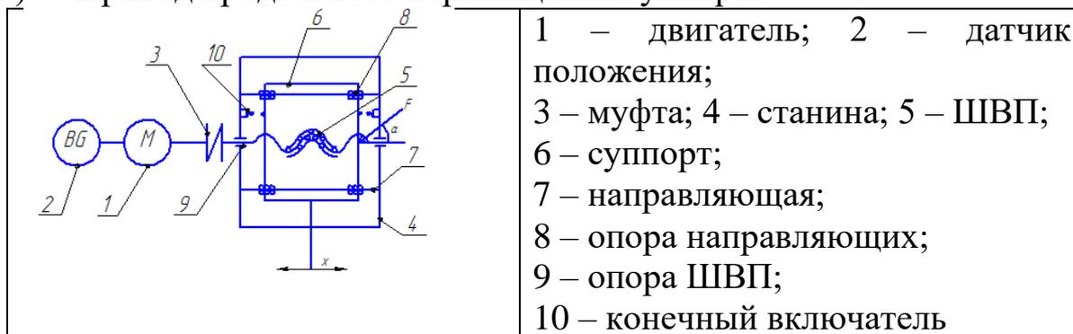
Вращение вала двигателя 1 через муфту 3 передается на шариковинтовую передачу 5, закрепленной в опорах 9. Суппорт 6 совершает передвижение на направляющих 7, ограниченное конечными выключателями 10, вдоль станины 4.
