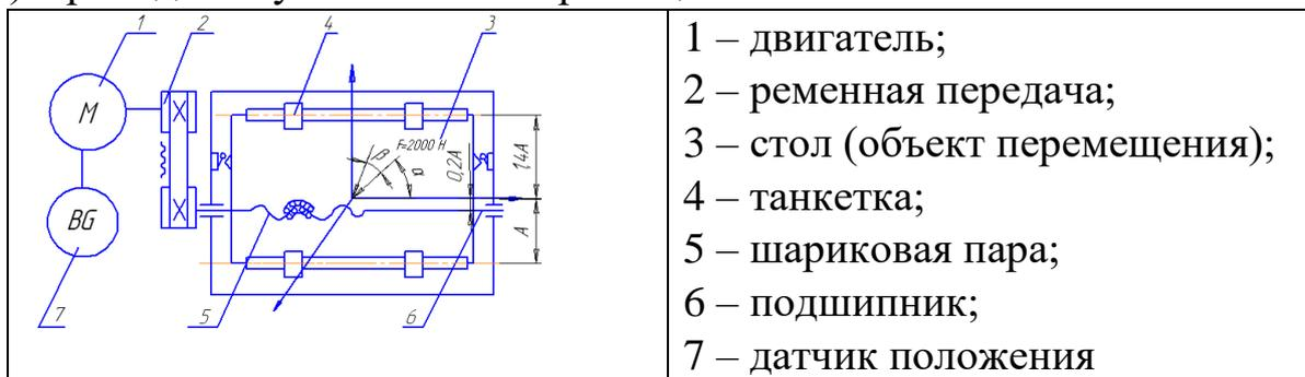
Двигатель 1 вращает вал ременной передачи 2, которая вращает вал шариковой пары 5, что позволяет столу 3 перемещаться.
