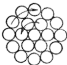
Рис. 85 - Конструкция грозотроса ТК-50
