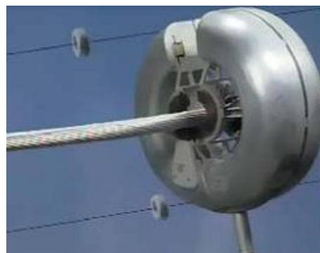
Рис. 42. Монтаж измерительного блока на проводах ЛЭП
