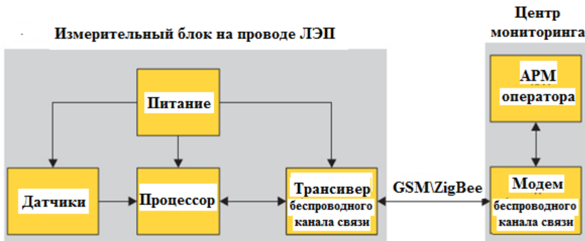
Рис. 37. Система мониторинга пропускной способности проводов ЛЭП
