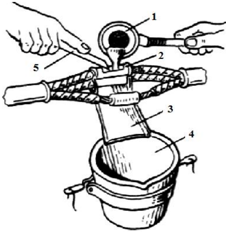
Рис. 103. Соединение жил пайки поливом расплавленного припоя: 1 – ложка паяльная; 2 – форма; 3 – лоток; 4 – тигель; 5 – скребок
