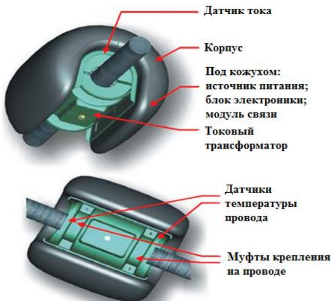
Рис. 40. Общий вид прибора OTLM
