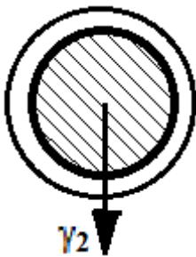
Рис. 88. Тяжение провода от веса гололёда
