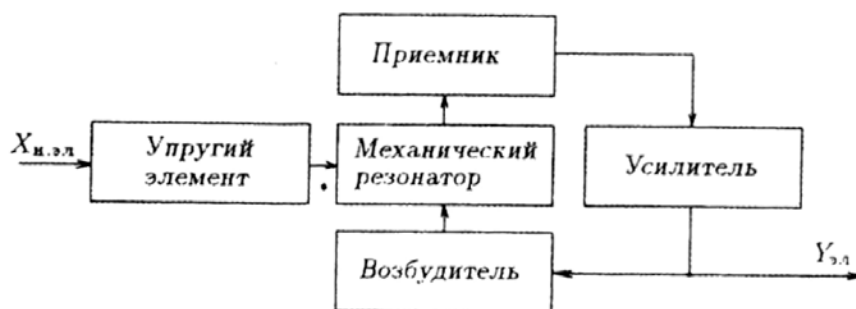
Рис. 2.27. Структурная схема частотного преобразователя с резонатором, работающим в автоколебательном режиме
