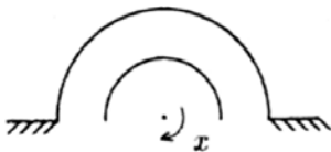
Рис. 2.18. Емкостной преобразователь с переменной активной площадью обкладок
