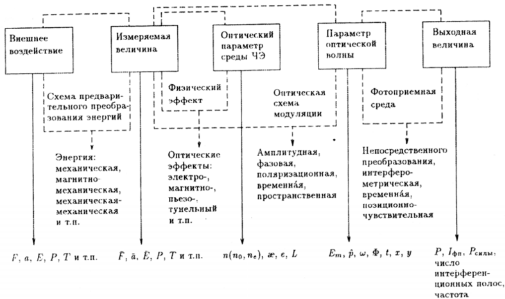
Рис. 2.54. Структура преобразований в ВОД
