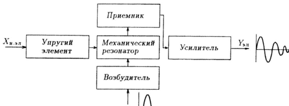
Рис. 2.26. Структурная схема частотного преобразователя с резонатором, работающим в режиме свободных колебаний
