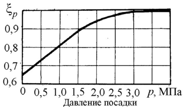
Рис. П2. Зависимость поправочного коэффициента \xi_p от давления посадки (K_\sigma)_p = \xi_p (K_\sigma)_{p \geq 30 \text{ МПа}} , где \xi_p = (K_\sigma)_p / (K_\sigma)_{p=30}
