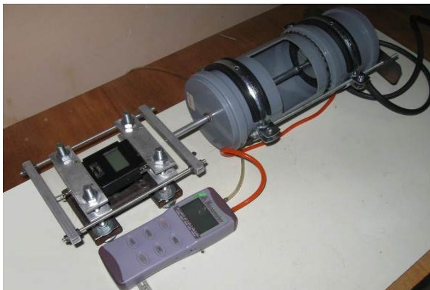
Рис. 6.3. Общий вид лабораторного стенда исследования одномоembrанного преобразователя
