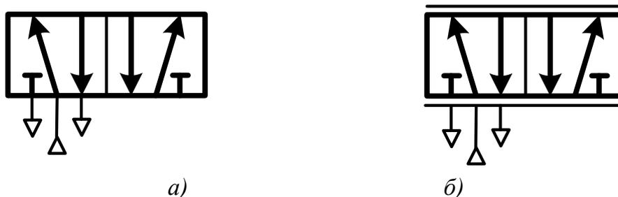
Рис. 9.2. Условное графическое обозначение распределителей:
