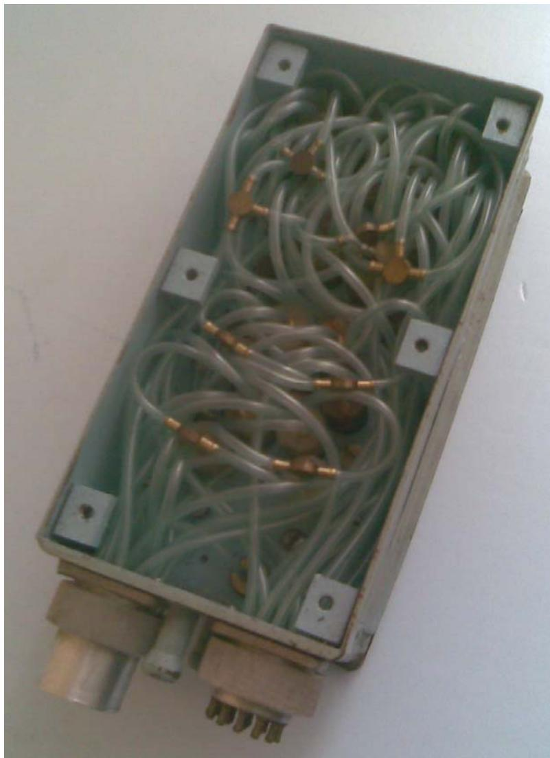
Рис. 8.5. Камера блока системы управления струйных турбулентных логических элементов
