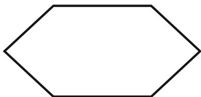
Рис. 17. Блок цикла. Общее обозначение
