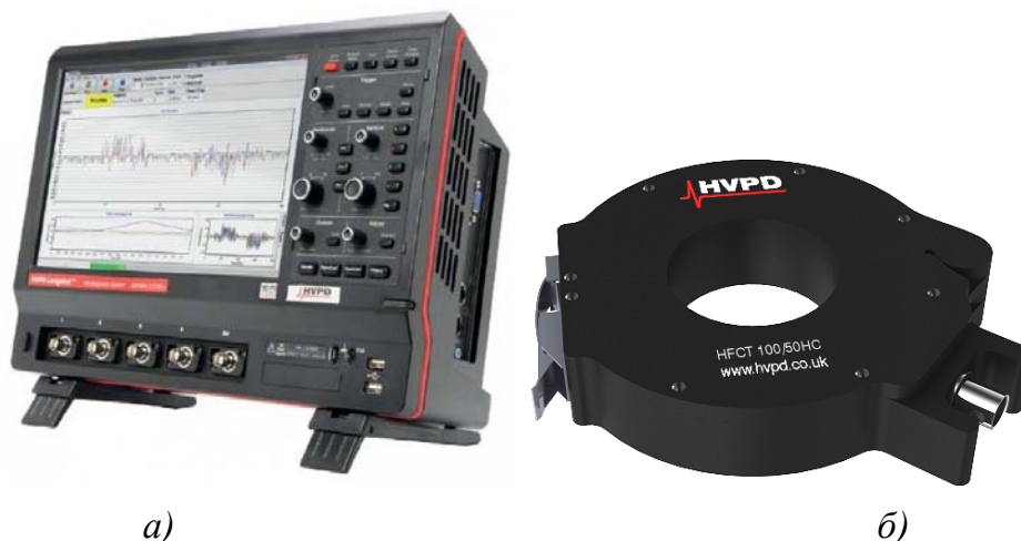
Рис. 9.6. Компоненты устройства: а – цифровой регистратор; б – датчик ЧР
