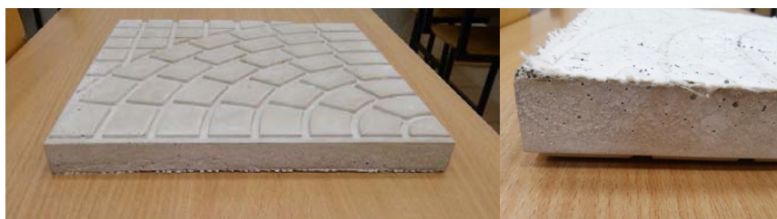
Рис. 4. Образец плитки из хризотилмагнезита
