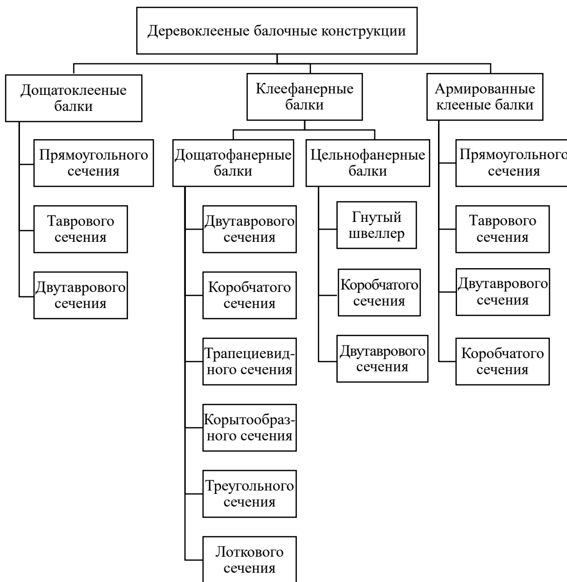
Рисунок 5.1 – Виды деревяноклееных балок
