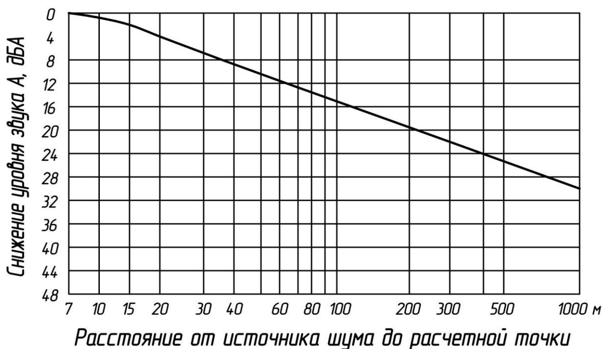
Рис. 67. График для определения снижения уровня звука в зависимости от расстояния между источником шума и расчетной точкой
