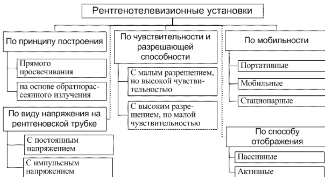
Рис. 7. Классификация рентгентелевизионных установок
