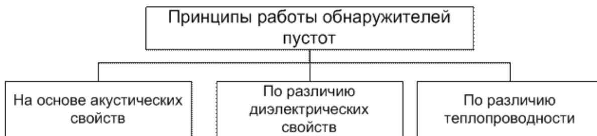
Рис. 6. Принципы обнаружения пустот
