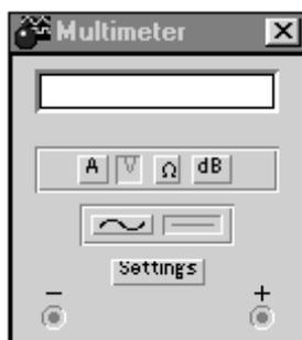
*Мультиметр* (Multimeter) измеряет действующие или постоянные значения напряжений и токов, сопротивления и ослабления (затухания). Кнопка Setting служит для установки параметров мультиметра.
