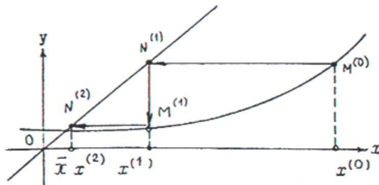
Рис. 3. Процесс вычисления приближений метода простой итерации.
