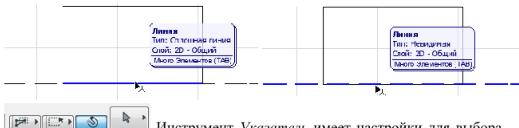
Инструмент *Указатель* имеет настройки для выбора нескольких объектов, а также для удобства выбора объектов, обладающих поверхностью или площадью (☺ - метод быстрого выбора).
