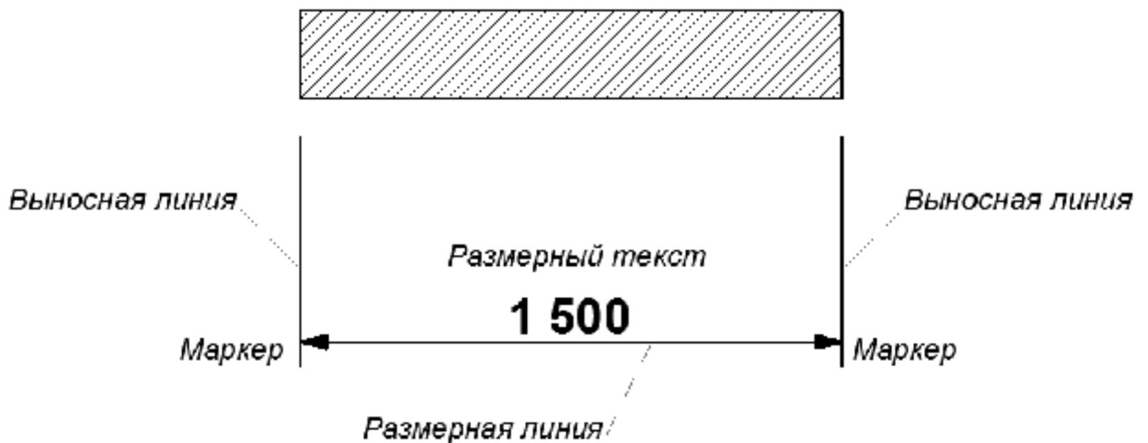
Всем элементам линейного размера назначаются параметры в разделах **ТИП РАЗМЕРА, СТИЛЬ ТЕКСТА**
