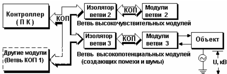
Рис. 2.19. Система развязки приборов КОП
