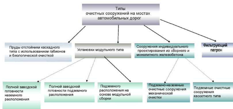
Рис. 1. Типы очистных сооружений на мостах
