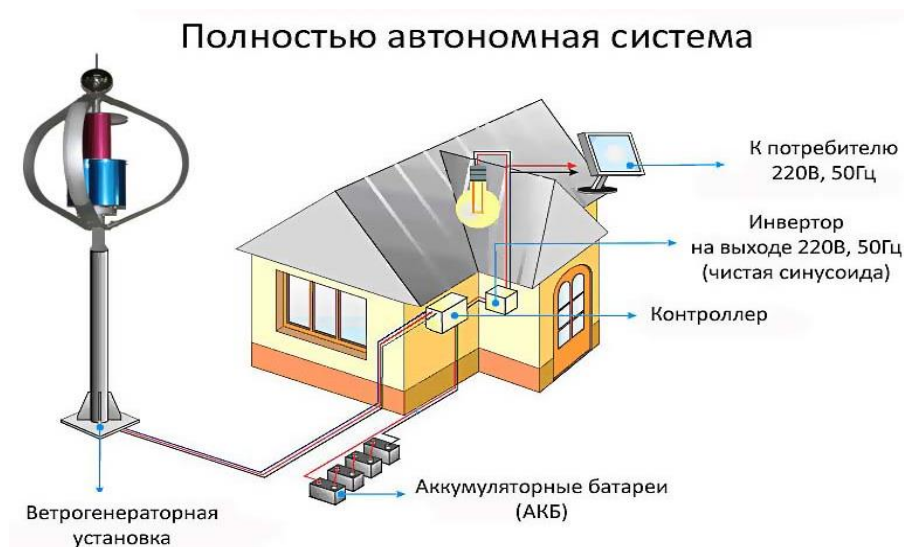
Рис. 1. Автономная система электроснабжения с использованием ветрогенераторной установки
