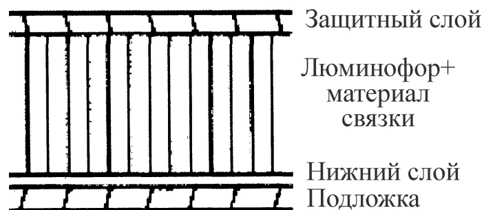
Рис. 2.19. Структура флуоресцентного экрана
