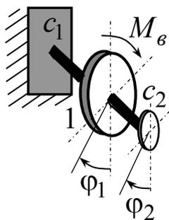
Для гашения крутильных колебаний диска 1 присоединяется диск 2 с моментом инерции  $I_2$  на валу жесткости  $c_2$ .
