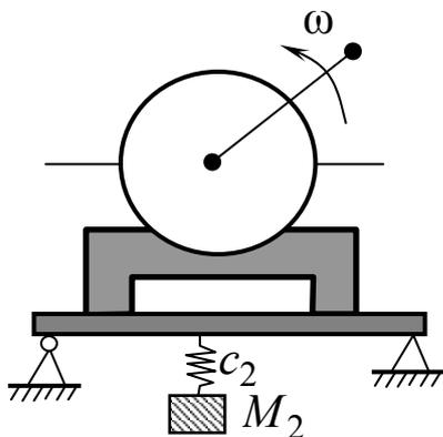
Ротор электродвигателя не уравновешен. Чтобы погасить колебания основания, нужно подвесить груз  $m_2$  на пружине жесткостью  $c_2$ .
