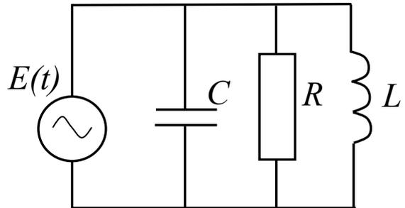
Рассмотрим электрическую цепь с параллельным соединением элементов. Согласно I закону Кирхгофа, запишем:
