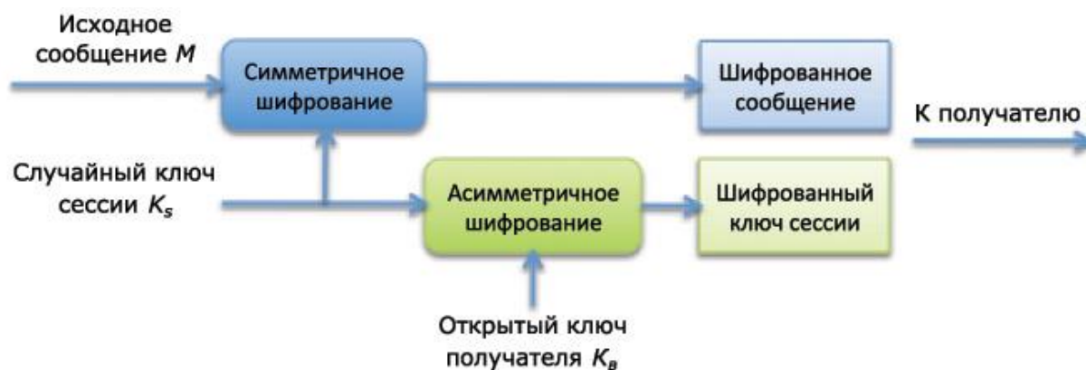
Рис. 31. Схема шифрования сообщения комбинированным методом
