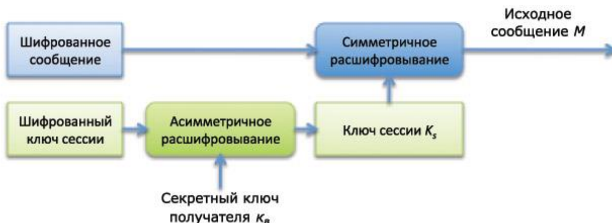
Рис. 32. Схема расшифровывания сообщения комбинированным методом
