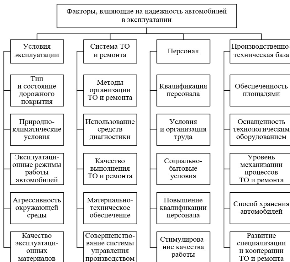
Рис. 8.1. Факторы, влияющие на надежность автомобилей в эксплуатации
