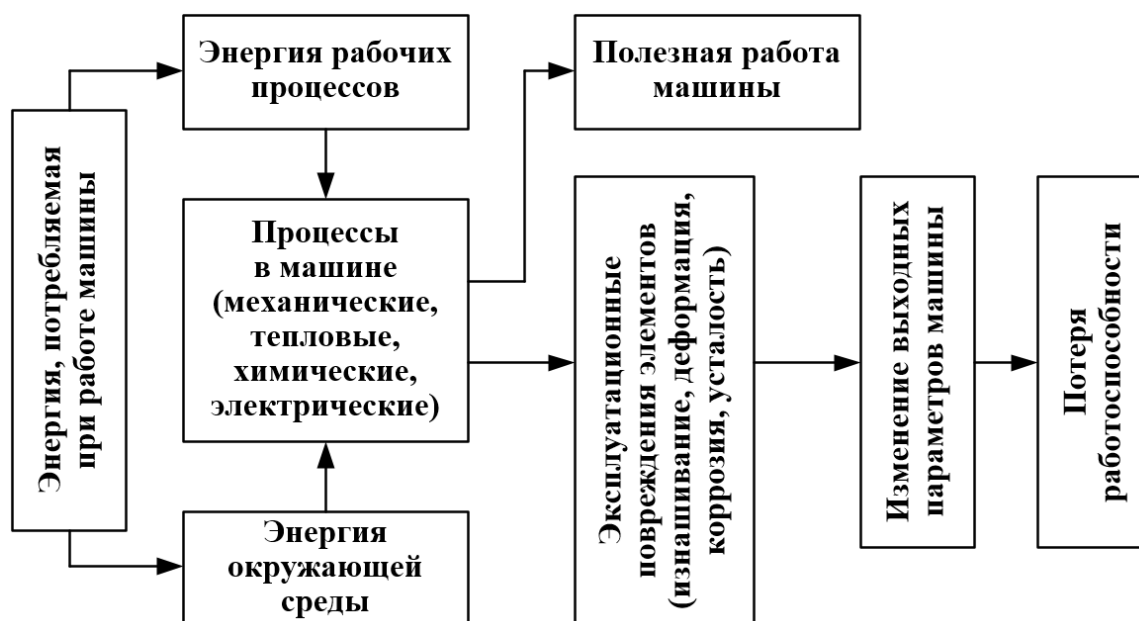
Рис. 2.1. Схема формирования процесса реализации машинной работоспособности
