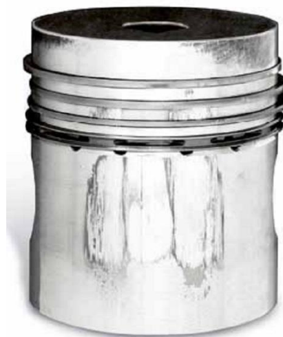
Рис. 8.2. Задиры на юбке поршня из алюминиевого сплава при работе с недостаточным количеством масла
