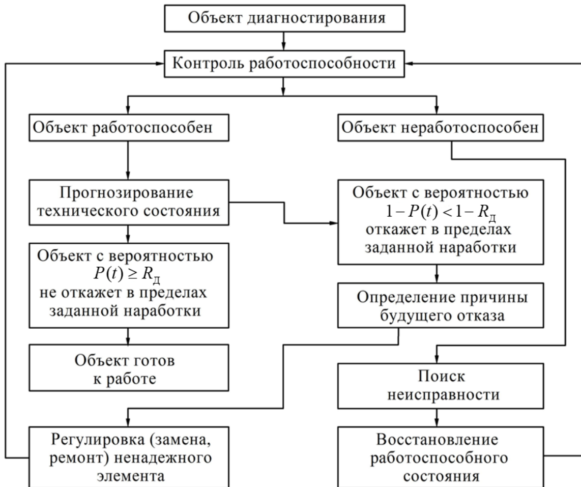
Рис. 8.8. Схема технического диагностирования автомобилей: R_d – заданная вероятность безотказной работы
