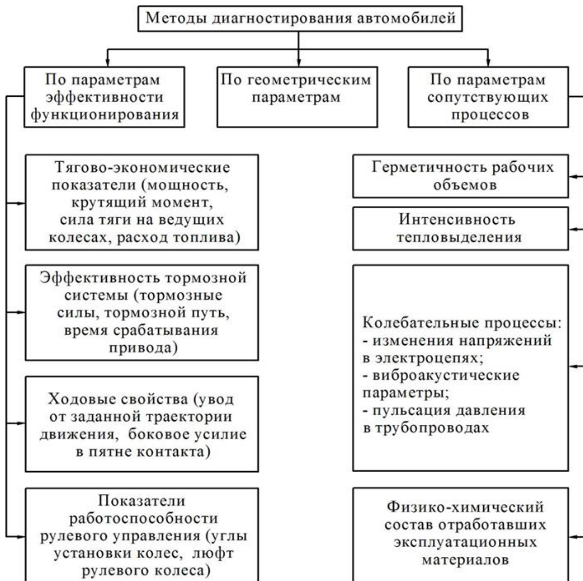
Рис. 8.9. Классификация методов диагностирования автомобилей
