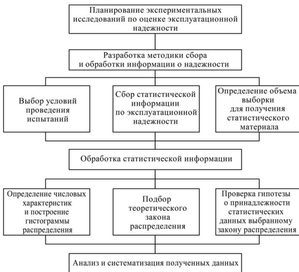
Рис. 5.5. Структурная схема экспериментальных исследований по оценке эксплуатационной надежности
