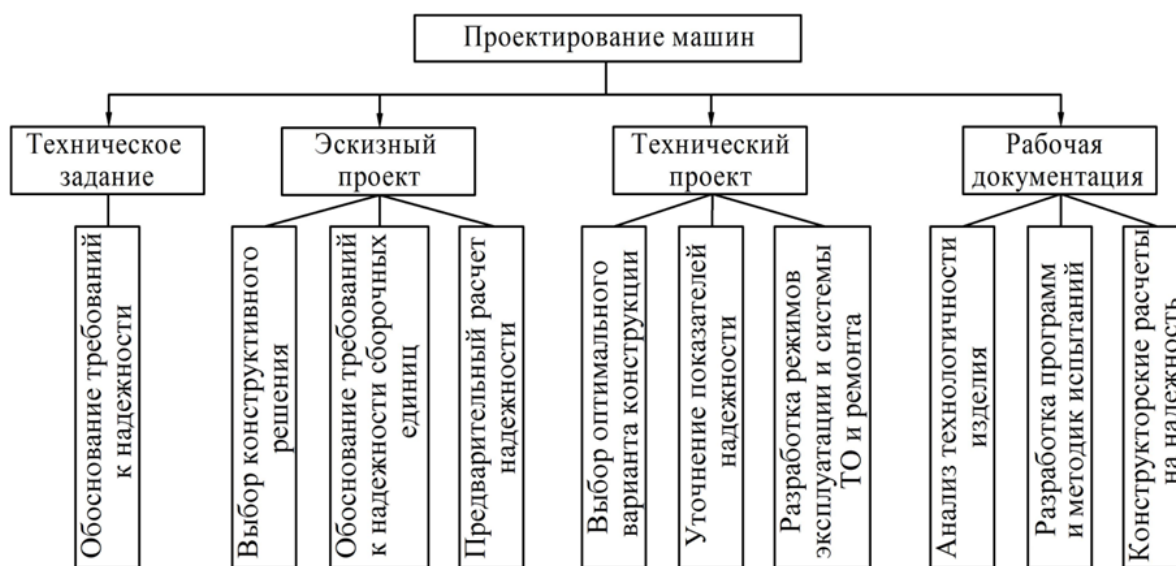
Рис. 7.2. Структурная схема процесса проектирования машины
