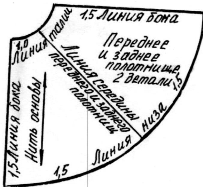
Рис. 36. Детали выкройки юбки «полусолнце»
