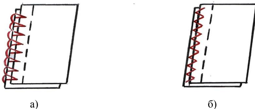
Рис. 27. Обработка срезов: а – на краеобметочной машине; б – зигзагообразной строчкой
