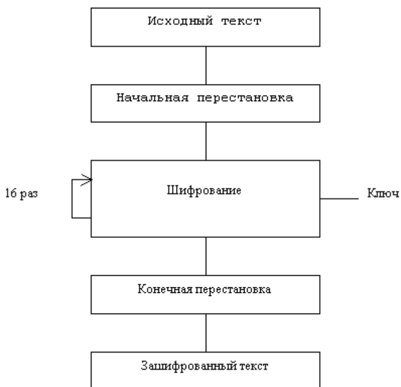
Рис.2. Обобщенная схема шифрования в алгоритме DES
