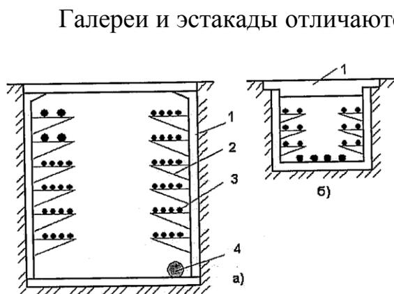
Рис. 3.27. Прокладка кабелей в тоннеле (а) и канале (б)
