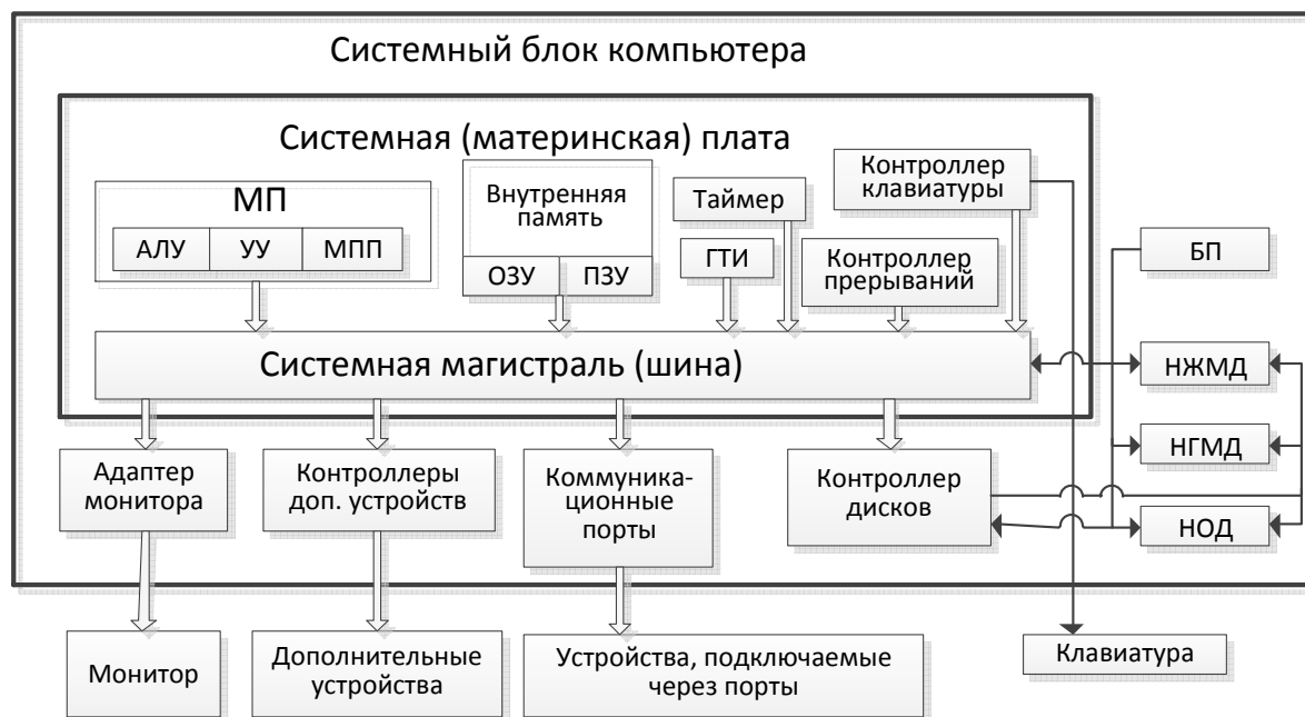
Рис. 5.3. Функциональная схема современной ЭВМ
