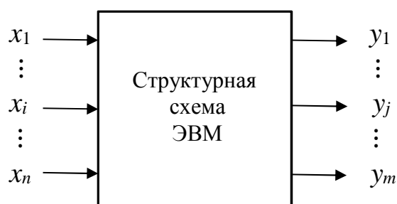
Рис. 3.2. Связь входных и выходных сигналов ЭВМ
