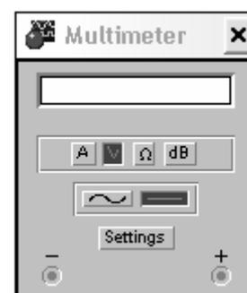
Рис. 3.2. Лицевая панель мультиметра
