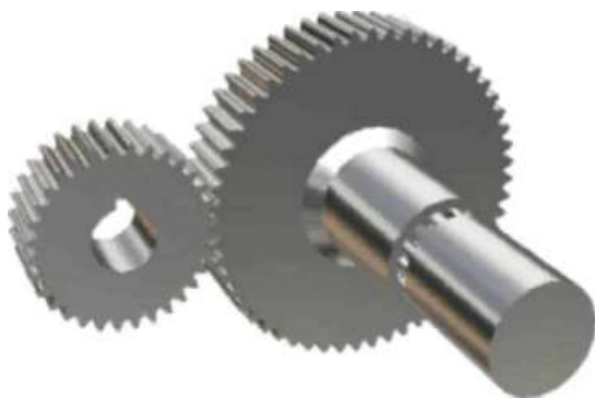
Рис. 35. Общий вид зубчатой передачи
