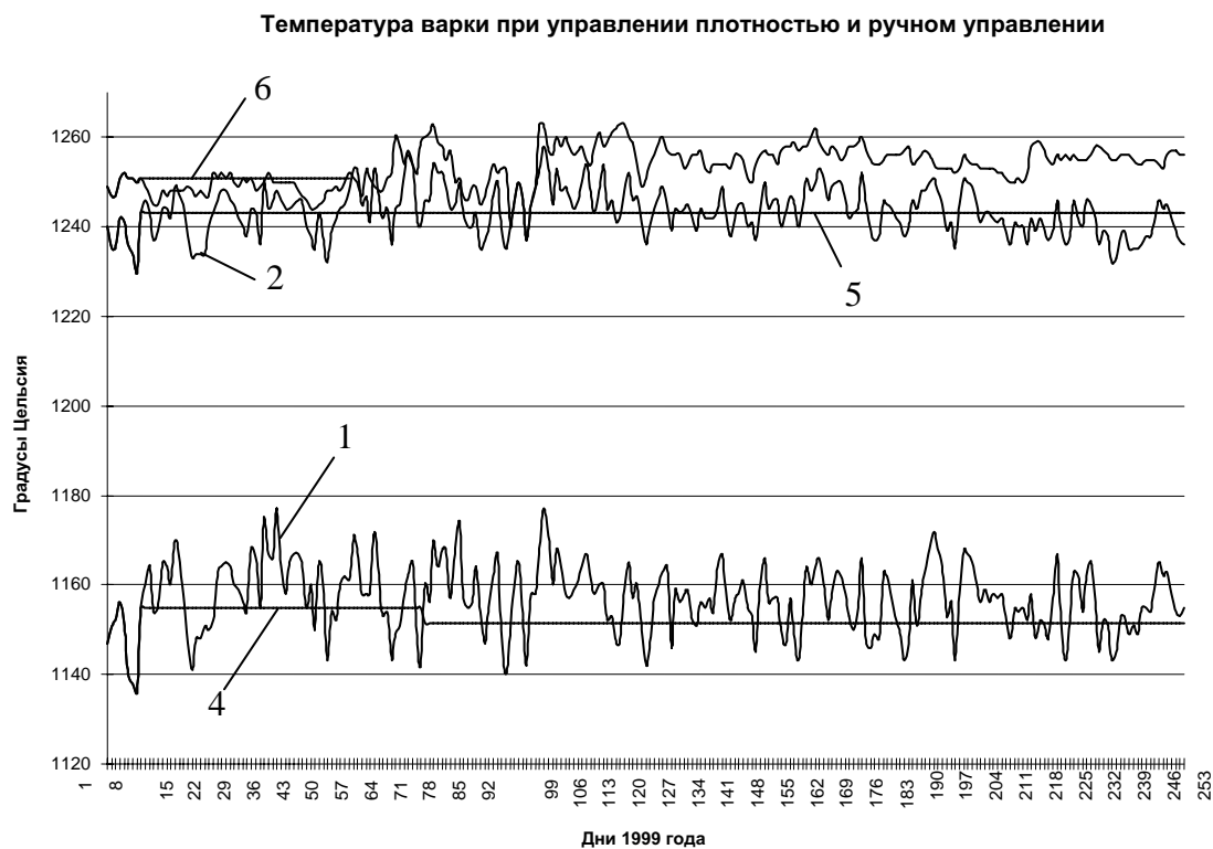
Рис. 4.12. Сравнение теплового режима работы ванной печи с результатами моделирования: 1, 2, 3 – температура \Theta_1, \Theta_2, \Theta_3 при ручном ведении процесса; 4, 5, 6 – соответственно при управлении
