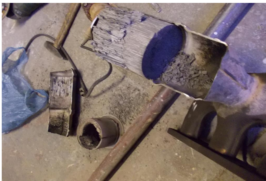
Рис. 1. Структура неисправного катализатора (разрушены соты), частицы катализатора в виде абразива перемещаются по всей выпускной системе, попадая в ТК
