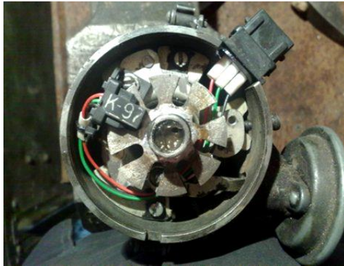
Рис.3. Внешний вид датчика Холла в автомобильных системах зажигания
