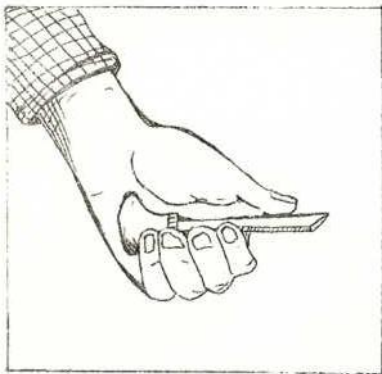
Рис. 18. Положение штихеля в руке
