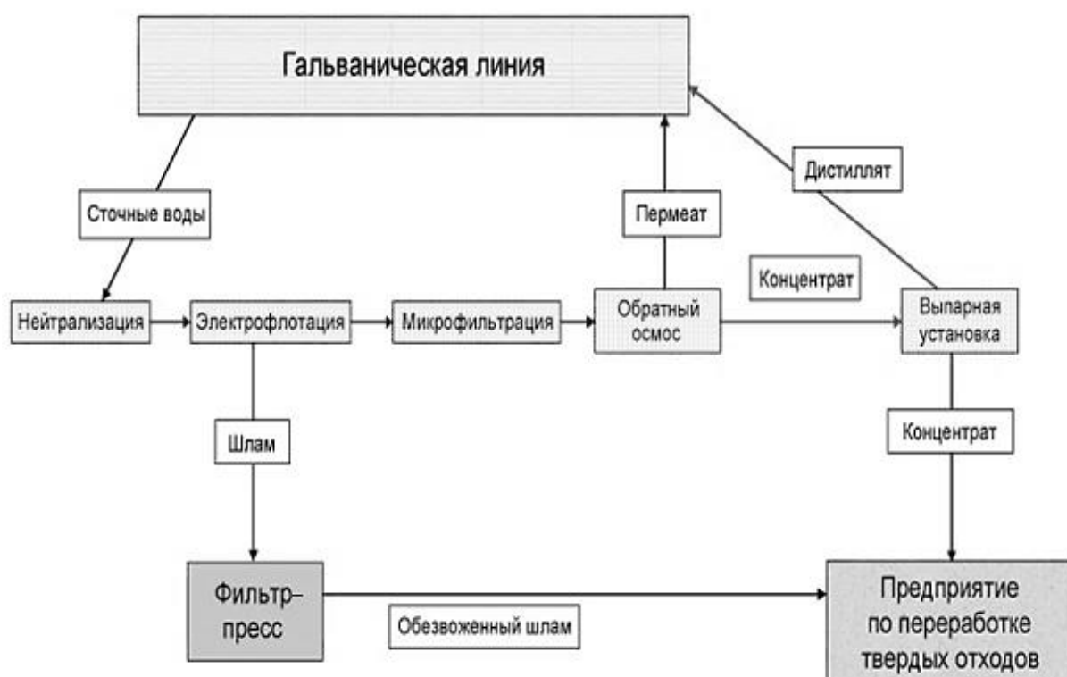
Рис. 2.6. Технология очистки гальванических сточных вод
