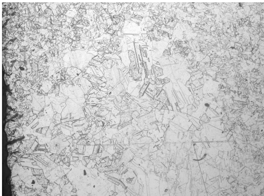
Рис. 8.3. Микроструктура меди М06 после рекристаллизационного отжига
