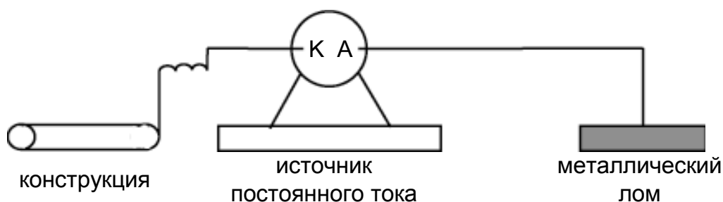
Рис. 4.6. Электрозащита от коррозии
