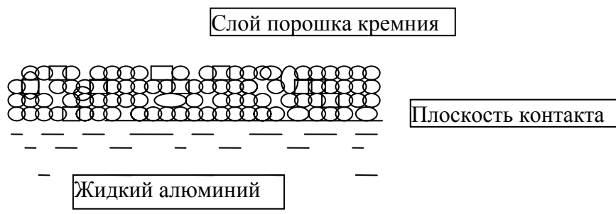
Рис. 3.1 Схема контакта слоя порошка кремния с жидким алюминием
