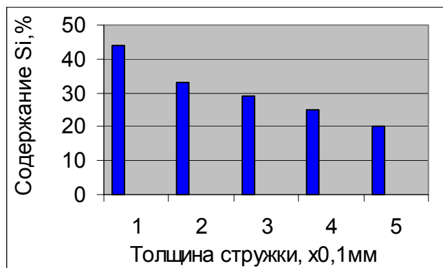
Рис.2.7. Оптимальное содержание пылевидного кремния в смеси со стружкой различной толщины
