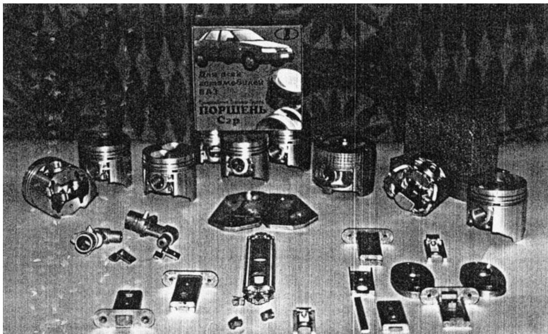
Рис. 5.13. Готовые отливки из сплава АК12, полученного с использованием пылевидного кремния
