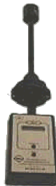
Внешний вид измерителя напряженности электростатического поля ИЭСП-01 с антенной
