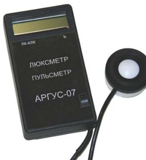
Рис. 6.1. Внешний вид люксметра-пульсметра «Аргус-07»
