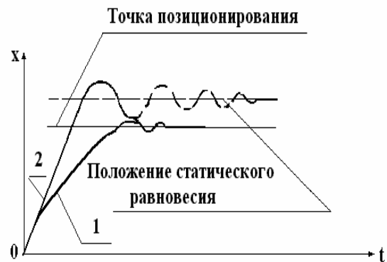
Рис. 2.2. Характер изменения скорости и координаты при положении статического равновесия дальше точки позиционирования
