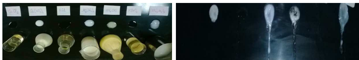
Рис. 3. Эксперимент с наклонной поверхностью для определения растекаемости экспериментальных образцов
