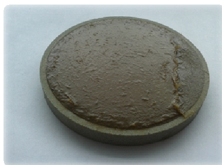
Рис. 3. Образование кольтматационной корки в процессе фильтрации блокирующего состава через керамический диск
