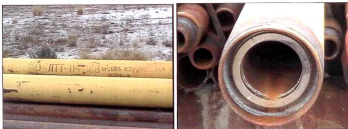
Фото 2. ТЛТ-168x114, установленные в скважинах №6401 и 6402
