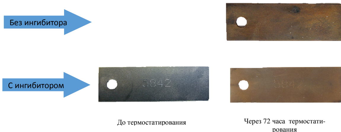
Рис. 2. Результаты тестирования насыщенных растворов на коррозионную активность
