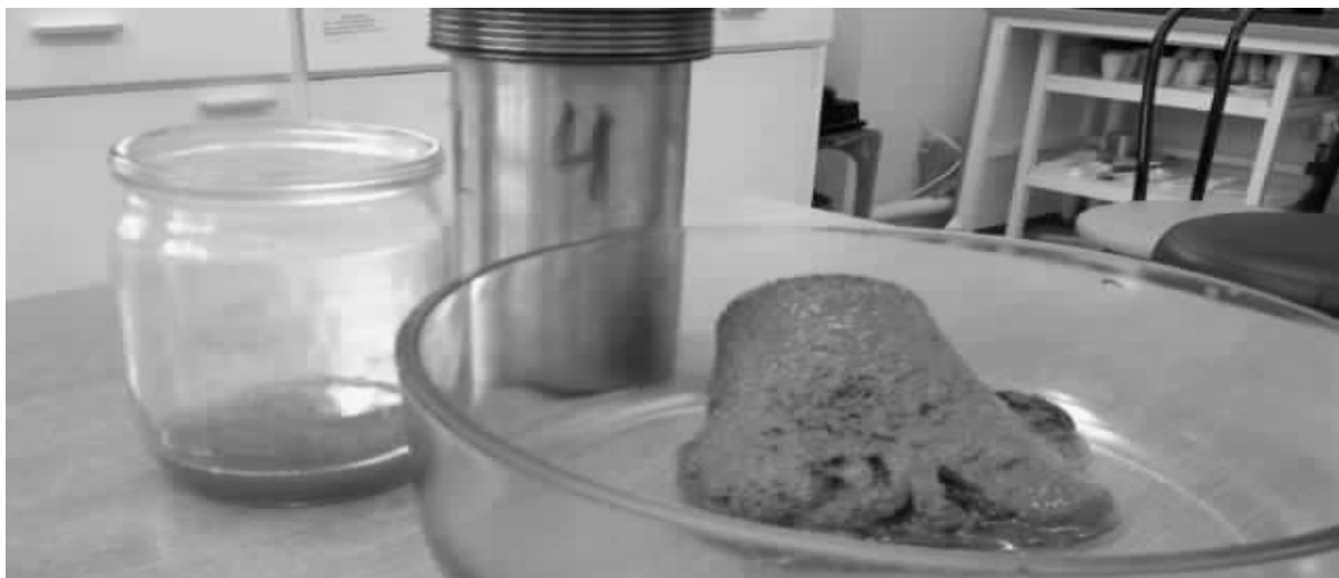
Рис. 1. Высокотемпературное «желирование» бурового раствора Без добавки реагента «ПолиGel»
