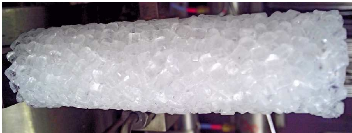
Рис. 2. Полученный образец из полистирола марки «ПСМ-115»
