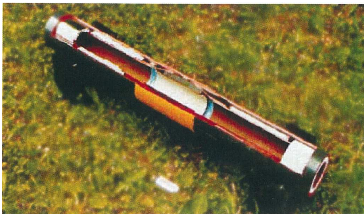
Фото 1. Теплоизолированная лифтовая труба (ТЛТ), установленная на скважине №6805
