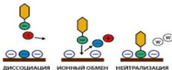
Рис. 1. Схема реакции при введении полифилизаторов в грунт
