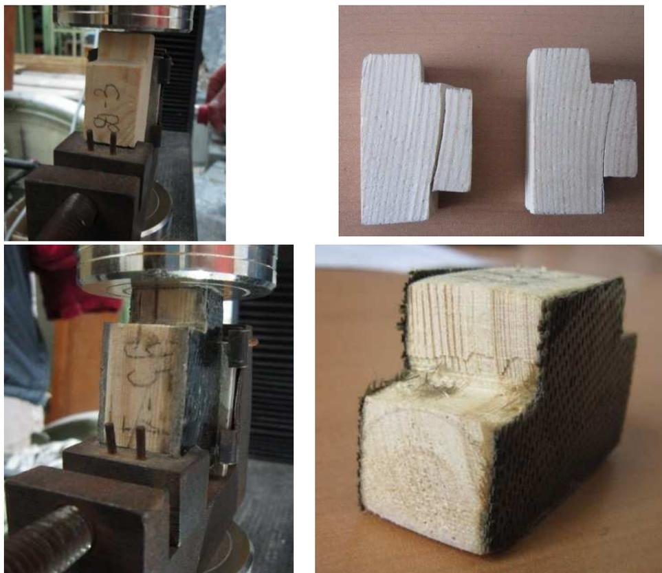
Рис. 2. Общий вид образцов во время и после испытания
