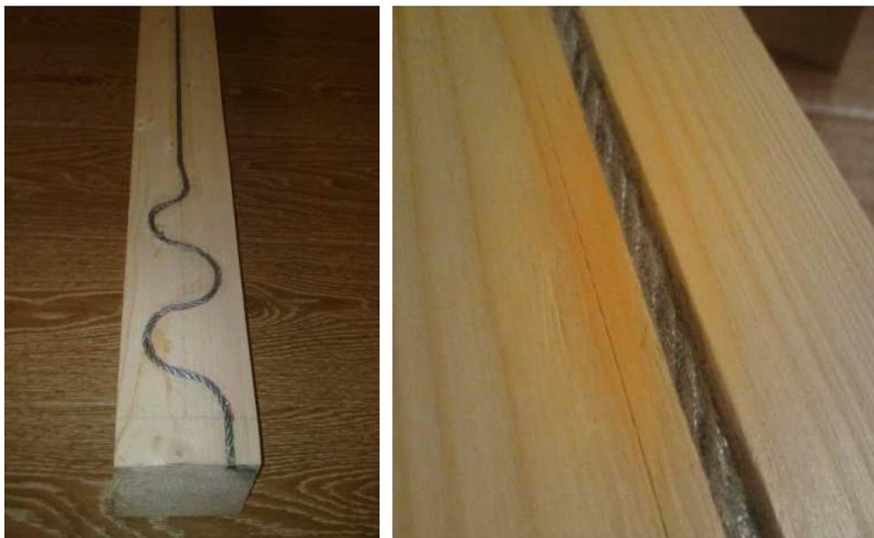
Рис. 5. Демонстрационный образец армированной канатом балки
