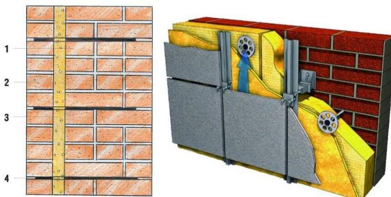
Рис. 3. Крепление стержнями Рис. 4. Крепление дюбелями
