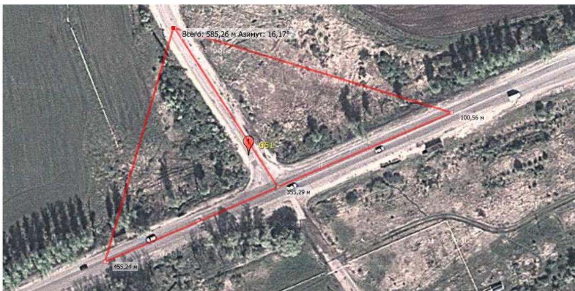
**Рис. 3. Пример измерения параметров  $L_a$  и  $L_d$  согласно требованиям [2] с помощью сервиса, предоставляемого сервером *Google map***
