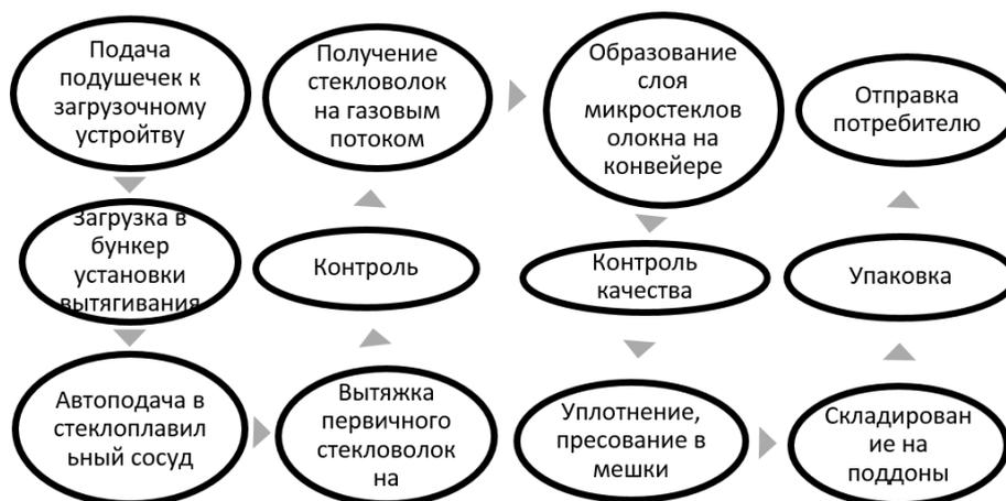
**Рис. 1. Стадии технологического процесса производства микростекловолокна**
