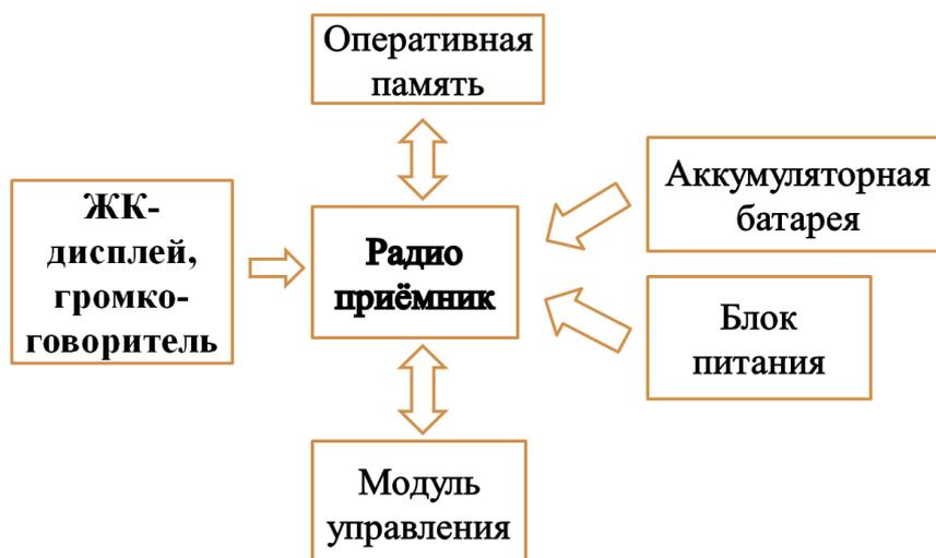
**Рис. 2. Структурная блок-схема устройства радиоприема**
