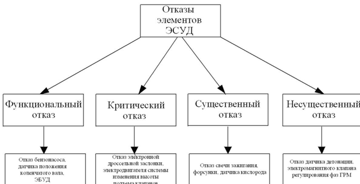
**Рис. Классификация отказов элементов ЭСУД**
