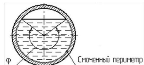
Рис. 2.1. Живые сечения: а – трубы; б – клапана
