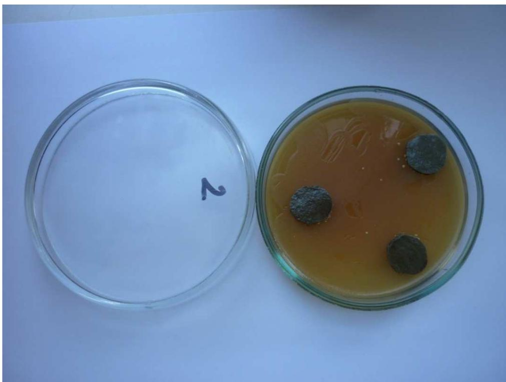
*Рис. 2. Результаты испытания степени бактерицидного действия наполнителя для полимерных композиций на основе гальваношлама*
