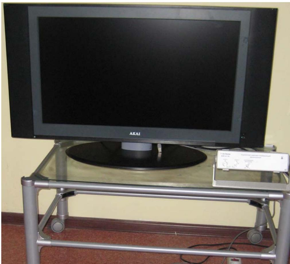
Комплект электронного видеовоспроизведения электрических процессов – телевизор с большой диагональю экрана, осциллограф двухканальный цифровой запоминающий АСК-3116 и ноутбук
