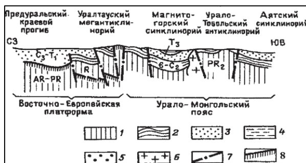
Рис. 2.19. Схематический тектонический разрез Урала (по А.С. Перфильеву): Структурно-формационные комплексы: 1 — основание, 2 — геосинклинальный, 3 — орогенный, 4 — плитный, 5 — активизации; 6 — гранитоиды различного возраста; 7 — крупные разломы; 8 — граница между комплексом основания и геосинклинальным комплексом «доуралид»
