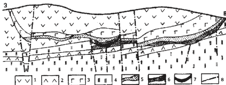
Рис. 5.9. Геологический разрез Норильского месторождения: 1 — базальты; — долериты; 3 — габбро; 4 — осадочные породы; 5 и 6 — вкрапленные руды; 7 — массивные руды; 8 — тектонические нарушения
