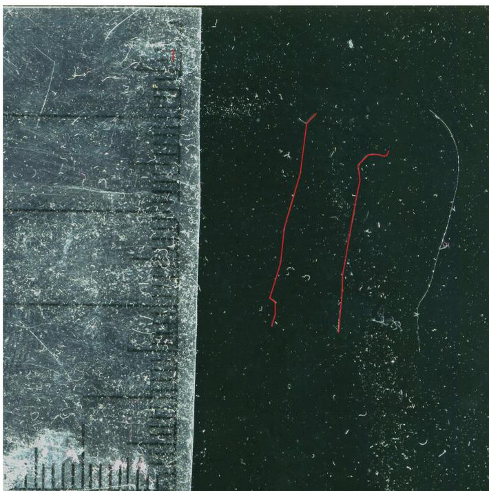
Рис. 1. Выделение длины сканированных волокон
