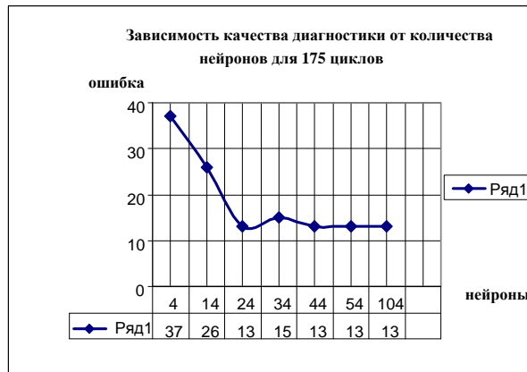
Рис. 4.5. График зависимости качества диагностики от количества нейронов: а – 100 циклов обучения, б – 150 циклов обучения, в – 175 циклов обучения
