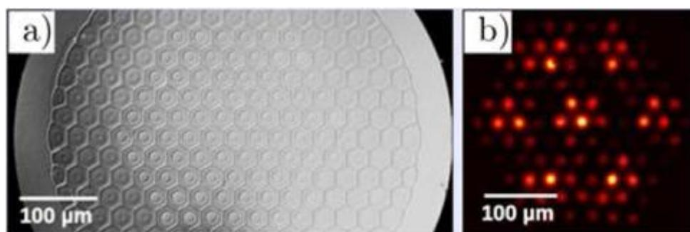
Рис. 21. Фотография массива, использовавшегося в эксперименте, (а). Выходное распределение интенсивности в массиве в линейном режиме длиной 50 мм (b)
