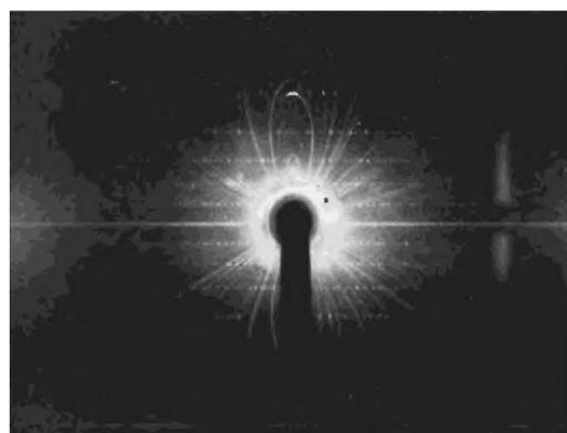
По расстояниям между слоевыми линиями определяют периоды повторяемости вдоль выбранного кристаллографического направления.
