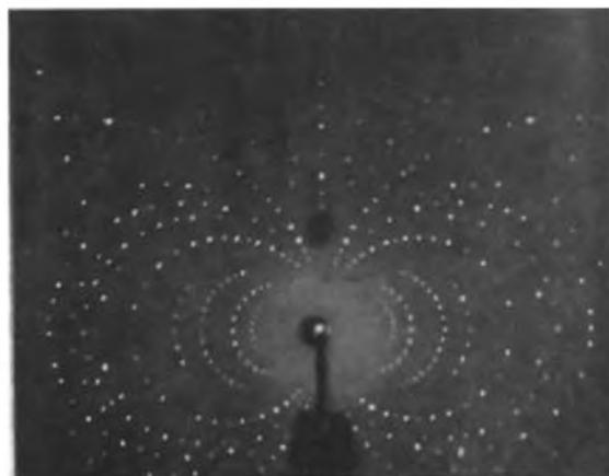
Если решётка кристалла обладает какой-либо симметрией, то при определённой ориентации кристалла эта симметрия проявляет себя на лауэграмме.
