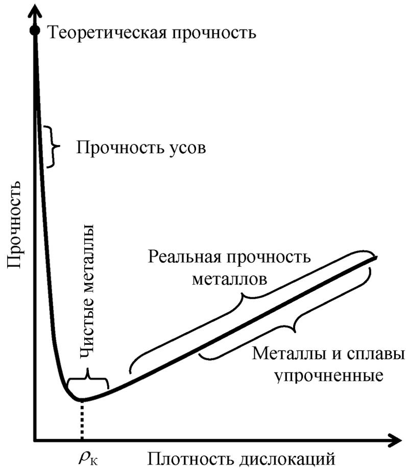
Дислокации влияют не только на прочность и пластичность, но и на другие свойства кристаллов. С увеличением плотности дислокаций изменяются оптические свойства, повышается электрическое сопротивление металла. Дислокации увеличивают среднюю скорость диффузии в кристалле, ускоряют старение и другие процессы, уменьшают химическую стойкость, поэтому в результате обработки поверхности кристалла специальными веществами в местах выхода дислокаций образуются ямки.
