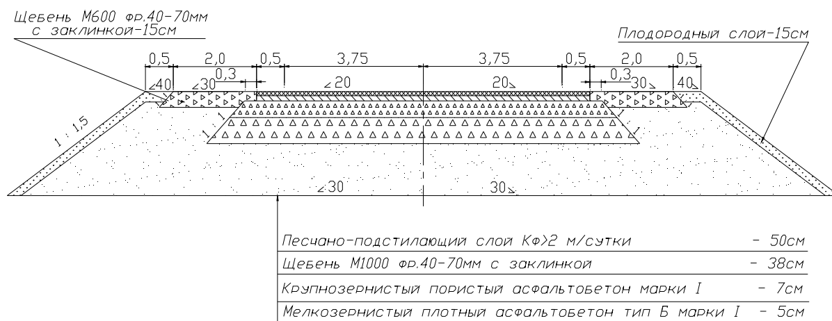
Рис. 7. Конструкция дорожной одежды
